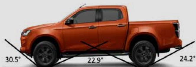
Gli angoli di attacco ed uscita sono stati ulteriormente migliorati grazie anche, e soprattutto, al nuovo paraurti posteriore integrato alla carrozzeria
