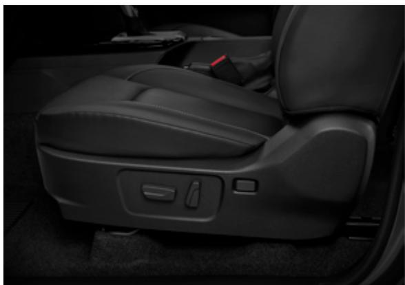
Sedile conducente elettrico. Sedili anteriori riscaldati.
