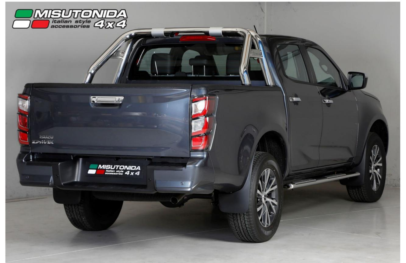
Rollbar, Hard Top, Soft Tonneau Cover e Shutter Lid vengono installati solo con la vasca senza bordi. NB: Non è garantita la tenuta dell'acqua.
