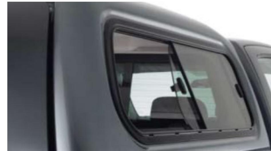
Rollbar, Hard Top, Soft Tonneau Cover e Shutter Lid vengono installati solo con la vasca senza bordi. NB: Non è garantita la tenuta dell'acqua.
