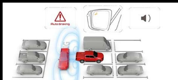
**RCTA (Rear Cross Traffic Alert) + RCTB (Rear Cross Traffic Brake).** Il sistema RCTA avvisa il conducente di veicoli in avvicinamento laterale durante le manovre di retromarcia, prevenendo collisioni. Il sistema RCTB frena il veicolo durante le manovre di retromarcia quando percepisce un veicolo in avvicinamento laterale, prevenendo collisioni.
