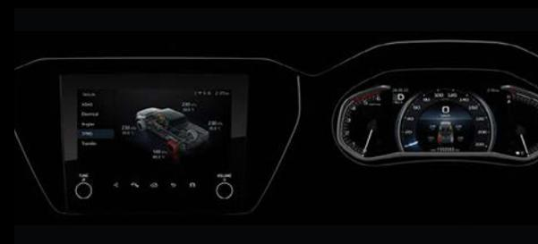
**TPMS (Tyre Pressure Monitoring System).** Il sistema permette di rilevare la pressione degli pneumatici del veicolo sul display del cruscotto, mantenendolo informato il conducente in caso ci sia qualche anomalia che possa pregiudicare la sicurezza di marcia.
