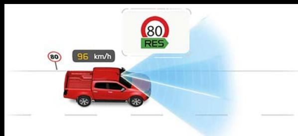
**ISL (Intelligent Speed Limiter).** Il sistema ISL regola automaticamente la velocità del veicolo in base ai limiti rilevati dai segnali stradali, mantenendo la velocità entro i limiti legali.
