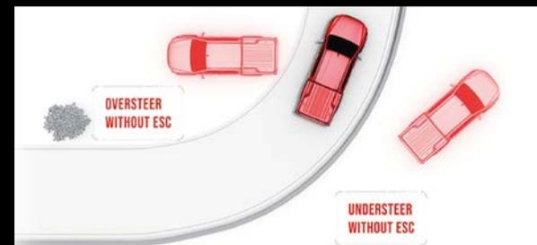
**ESC (Electronic Stability Control).** Il sistema ESC monitora costantemente la stabilità del veicolo e interviene automaticamente frenando singole ruote o riducendo la potenza del motore per prevenire il sottosterzo o il sovrasterzo, contribuendo a mantenere il controllo del veicolo in situazioni di emergenza o su strade scivolose.
