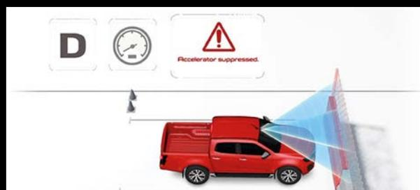
**MAM (Pedal Misapplication Mitigation).** La mitigazione dell'accelerazione involontaria si riferisce ai sistemi progettati per prevenire o ridurre la gravità degli incidenti causati da un'accelerazione accidentale davanti ad un ostacolo.
