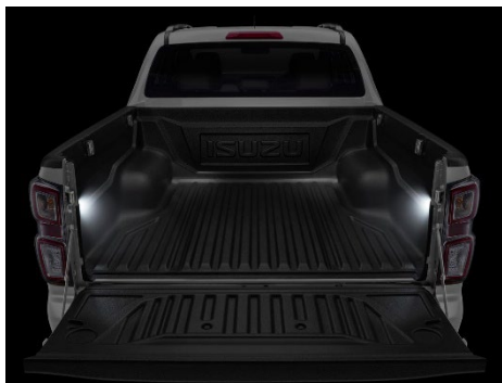
LED PER VANO DI CARICO
